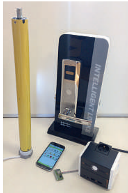
← Quelques démonstrateurs réalisés par Anyces avec, au centre, un téléphone montrant l'application ainsi que la carte électronique utilisée, et de gauche à droite, un moteur de volet roulant, une poignée de porte, et une simple multiprise qui devient un objet de domotique accessible pour tous (allumage, extinction, variation, programmation, régulation des appareils branchés sur cette multiprise).
